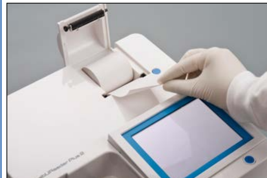
Slika 11: Nalaganje papirja za tiskalnik
