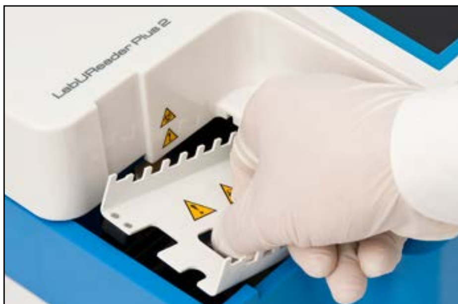
Slika 9: Vstavljanje tračnega časovnika
