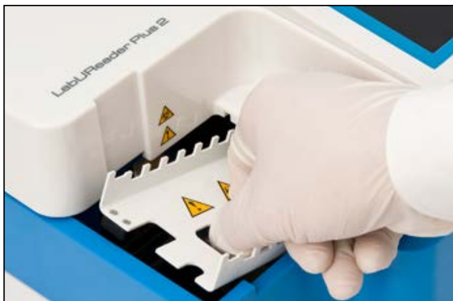
Фигура 9: Поставяне на рейката за синхронизиране на ленти
