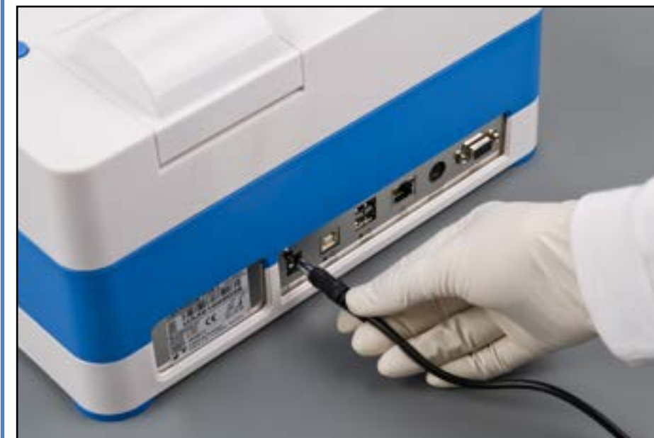
Фигура 7: Включване на анализатора към захранващата мрежа
