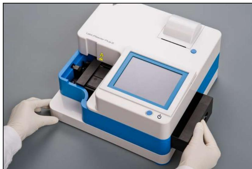
Figura 10: **Inserção da bandeja de fitas de teste**
