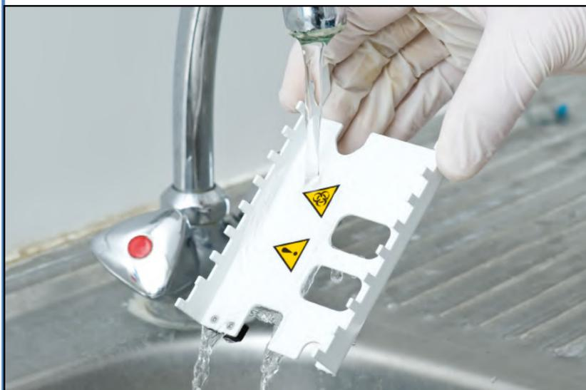
Figura 54: Enxaguamento do pente de cronometragem de fitas
