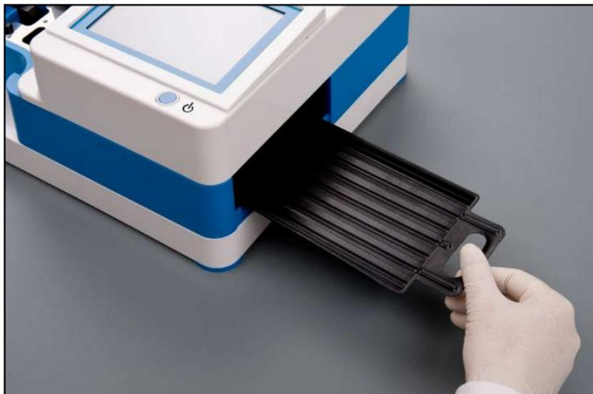
Figura 8: **Inserção da bandeja de gotejamento**
