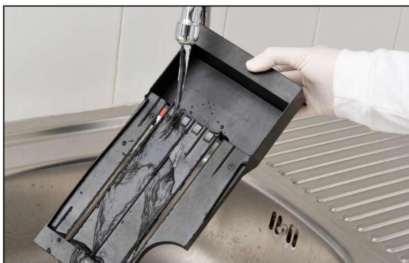
Figura 53: Enxaguamento da bandeja de fitas de teste
