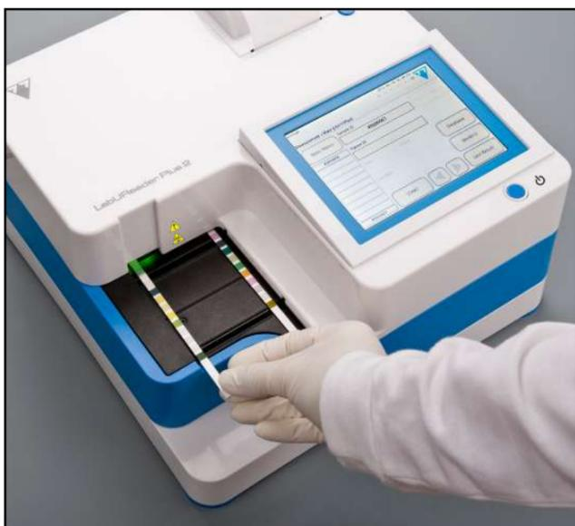
**4** Quando aparecer uma luz verde contínua na zona de colocação de fitas, coloque a fita reagente na bandeja de fitas de teste, dentro da zona de colocação de fitas, com os blocos de teste virados para cima.
