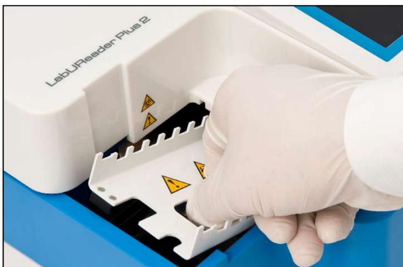
Figura 9: **Inserção do pente de cronometragem de fitas**
