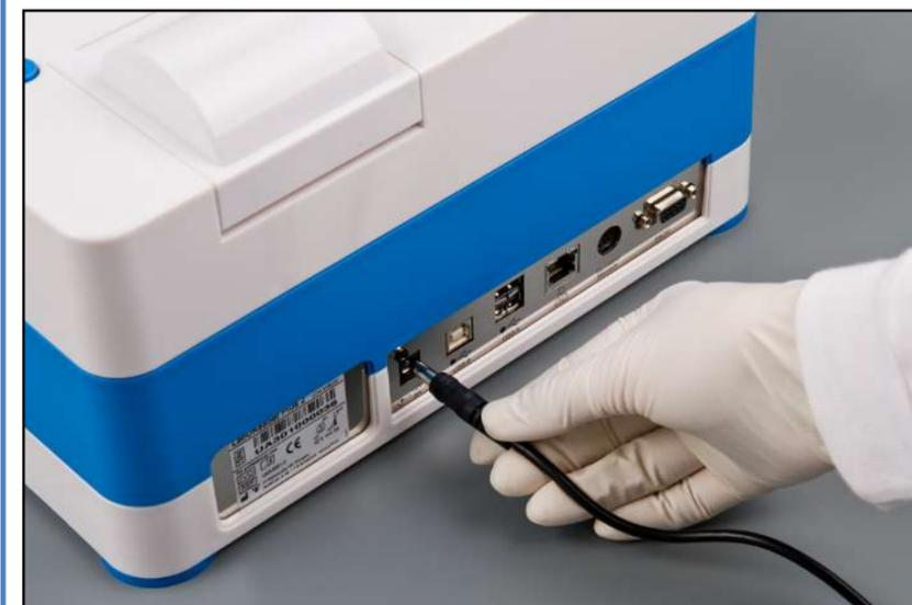
Figura 7: Ligação do analisador à rede elétrica
