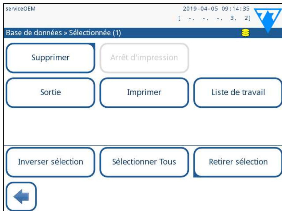
Figure 29: Le menu Base de données»Sélectionnés (Database»Selected) avec trois enregistrements sélectionnés, indiqué dans la barre d'état
