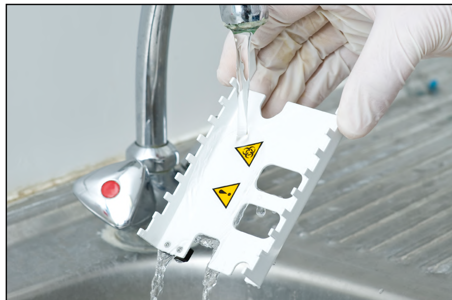
Figuur 54: De striptimerhark spoelen
