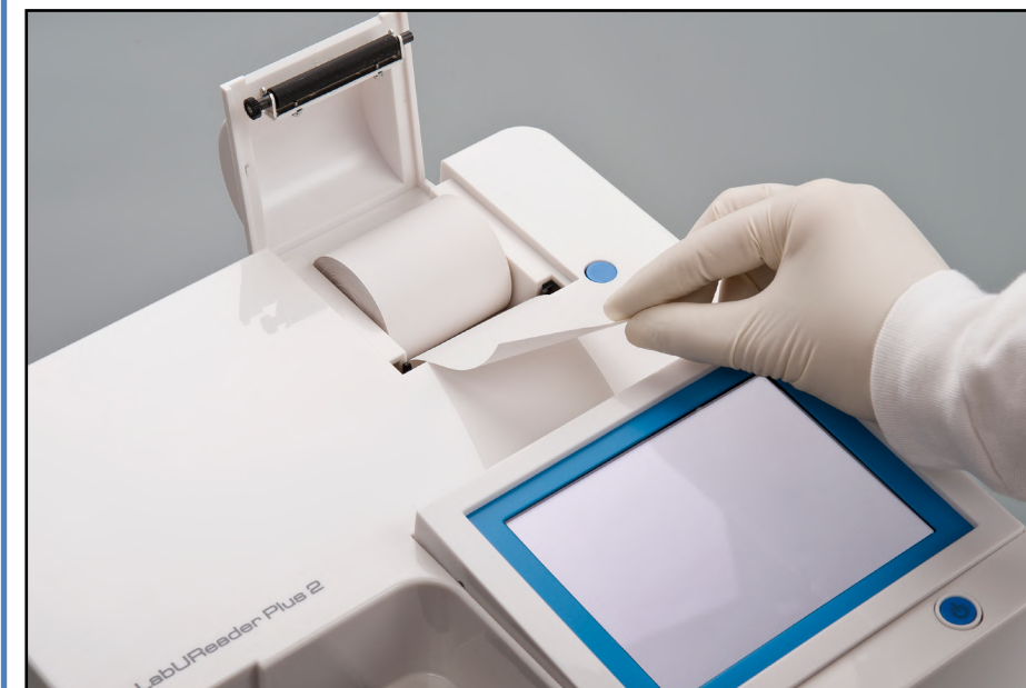
Figuur 11: Printerpapier laden
