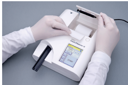
Fig. 4: De printer laden
