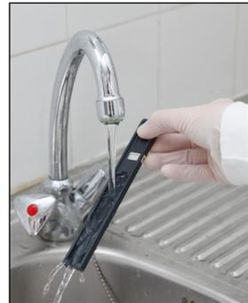
**Fig. 23:** Enxaguamento da bandeja de fitas de teste
