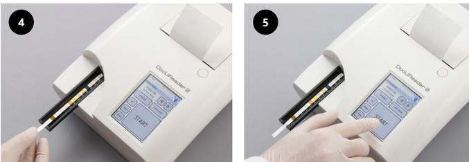
4. Coloque a fita de teste no canal da mesa com os blocos de teste virados para cima.
