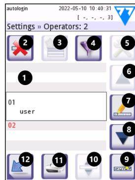
**Fig. 21:** O ecrã de Definições » Operadores (Settings » Operators) com legenda dos botões
