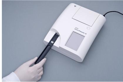
**Fig. 3:** *Inserção da bandeja de fitas de teste*
