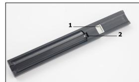
**Fig. 22:** Il supporto per striscia reattiva e il suo tampone di riferimento
