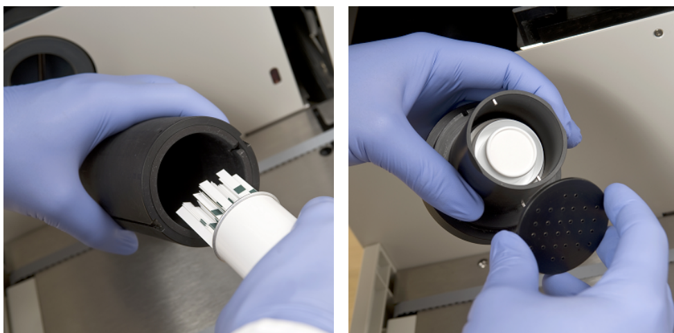
Slika 22: Nalaganje preskusnih trakov in sušilnega sredstva v jeklenko za nalaganje traku
