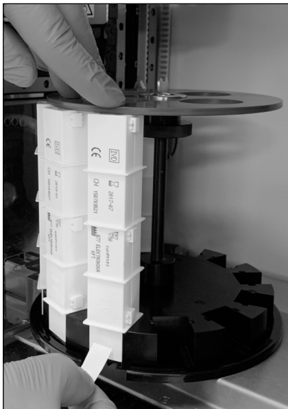
Фиг. 59. Зареждане на въртящата се въртележка за кювети
