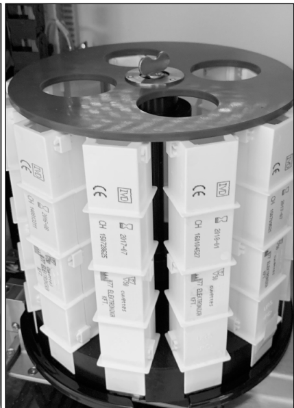
Фиг. 60. Напълно заредена въртяща се въртележка за кювети
